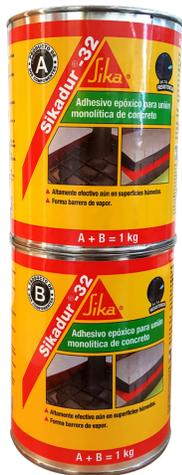
Es un adhesivo epóxico de 2 componentes, de consistencia líquida y libre de solventes. Para uso como adhesivo estructural de unión monolítica de concreto fresco con concreto endurecido; entre elementos de piedra, mortero, acero, hierro, fibrocemento, madera o en anclajes de pernos en concreto o roca.
