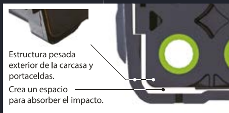
Estructura de absorción de impacto.
